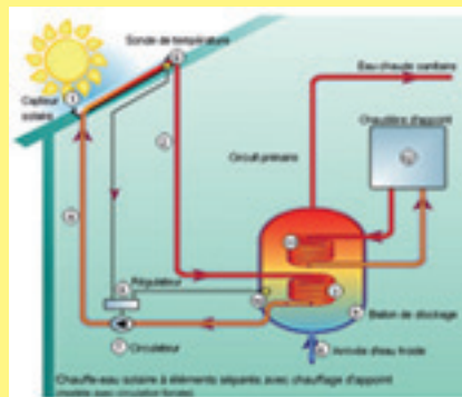
Schéma d'une production d'eau Chaude Sanitaire Solaire avec une chaudière d'appoint.
